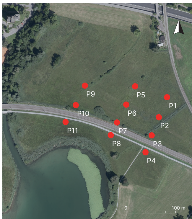
Abb. 4a u. 4b. Lage, Verteilung und Bezeichnung der Piezometer in Zug ZG-Sumpf (1:4500) und Risch ZG-Oberirisch, Aabach (1:1000). Die Abbildungen sind genordet. Luftbild Amt für Grundbuch und Geoinformation ZG, Grafik Eva Kläui, ADA ZG.
