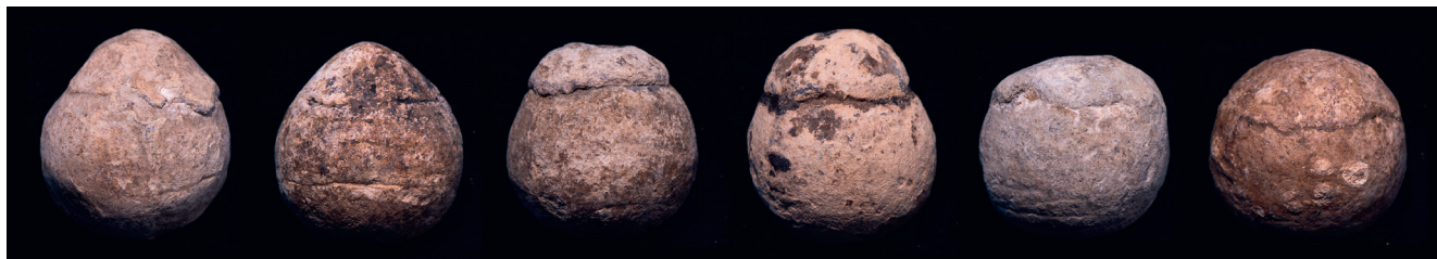
Abb. 4. Auswahl der in der Stichprobe der Kugeln vom Panixerpass gefundenen Exemplare mit gehämmerten Gusshälsen. Kugeldurchmesser 18,3–18,7 mm. Foto H. Hübner.
