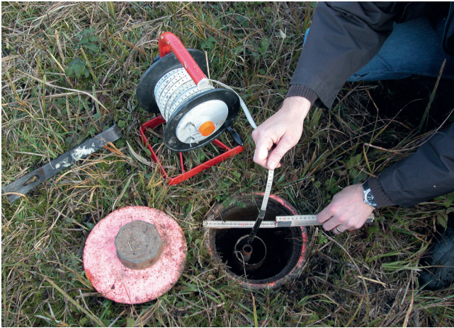
Abb. 5. Piezometer in der spätbronzezeitlichen Seeufersiedlung Zug ZG-Sumpf: Messung des Pegelstandes mit dem Lichtlot. Foto Stefan Hochuli, Archiv ADA ZG.
