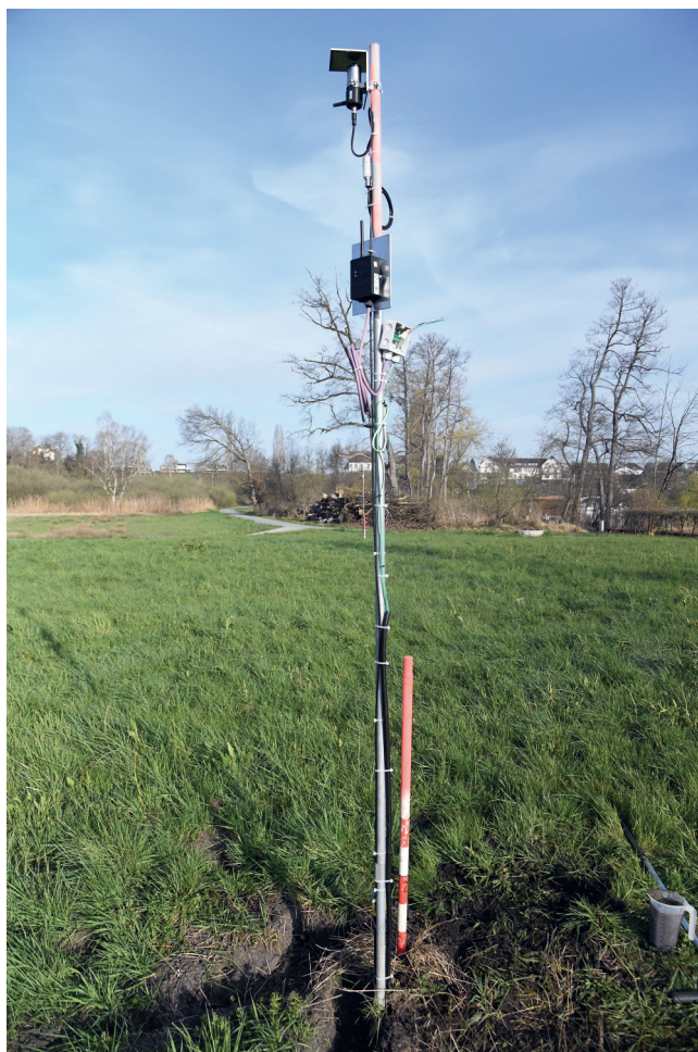
Abb. 15. Sursee LU, Halbinsel Zellmoos. Eine der sieben Messstationen, mit denen der Wasserstand und darüberliegende Feuchtigkeitssaum täglich automatisch abgelesen und in eine zentrale Rechenstation übertragen wird. Foto Remo Cortese, Kantonsarchäologie Luzern.
